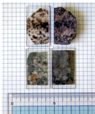
手作業で30ミクロンの厚さまで研磨した岩石薄片が解析の基本となる
