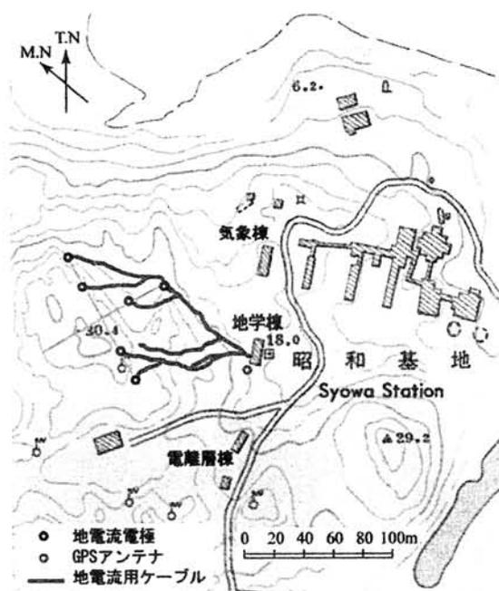
図1 2006年1月現在の地電流電極の位置と地学棟に引き込まれているケーブル。
