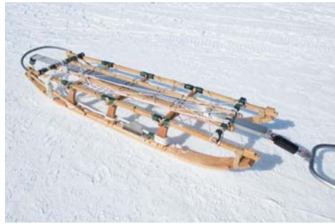
図 16 連結用の金属バーを組み込んだナンセンソリ Fig. 16. Nansen sled with a metal bar for linking with a cargo sled to transport rock samples.
