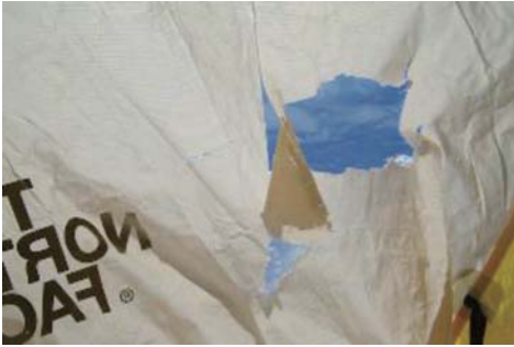
図 15 紫外線の影響で破れたドーム 5 テント 前室のフライ Fig. 15. Broken fly of the Dome 5 tent due to the effects of ultraviolet radiation.
