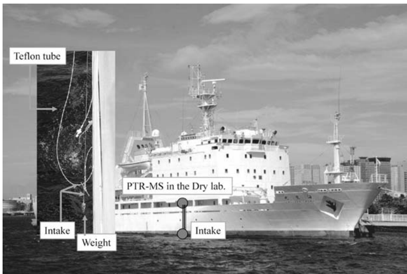
図 3 高度別観測時の空気取入口の様子. 上下に動かし 2 高度 (約 1.5m と 3m) から空気を取る. 丸は物理実験室と空気取入口. 海鷹丸の写真はホームページ http://www.wakanatsu.com/photo/umitakamaru.html から.
