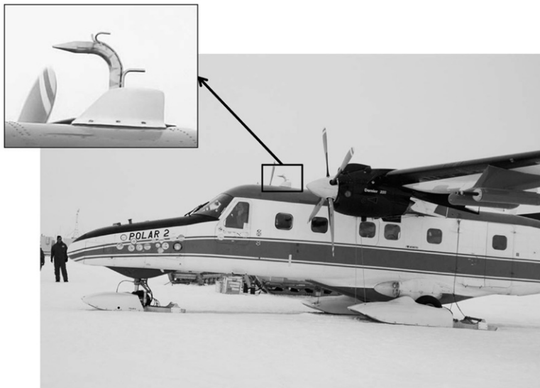
図3 ANTSYO-II: AGAMES で使用したエアロゾルインレットと航空機 (Polar-2) Fig. 3. Photograph of aerosol inlet and Polar-2 in ANTSYO-II: AGAMES.
