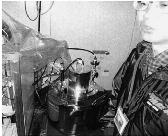
図1 昭和基地観測棟に設置したラドン濃度測定装置の外観
