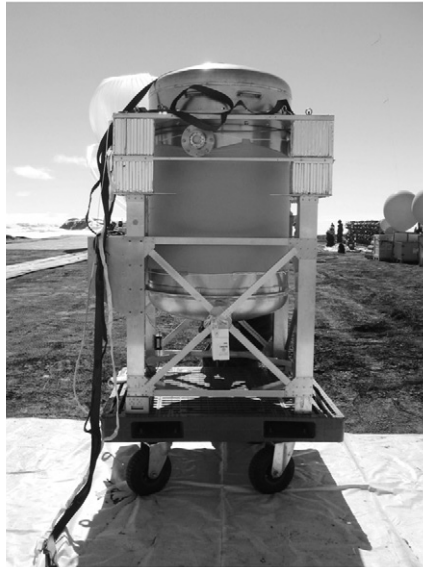
図2 南極の気球実験に使用されたクライオジェニックサンプラー Fig. 2. Photograph of the cryogenic air sampler.
