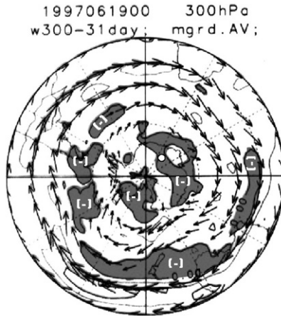
図8 1997年6月19日を中心とした31日平均の300hPaの絶対渦度の南北傾度の分布。負の領域を灰色で塗る。ドームふじ基地の位置を白丸で示す。
