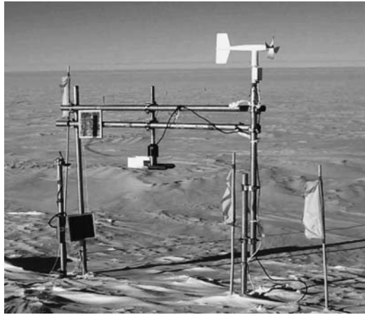
図 10 ドームふじ基地に設置されたスノーパーティクルカウンター (SPC). Fig. 10. Snow particle counter (SPC) set at Dome Fuji Station.
