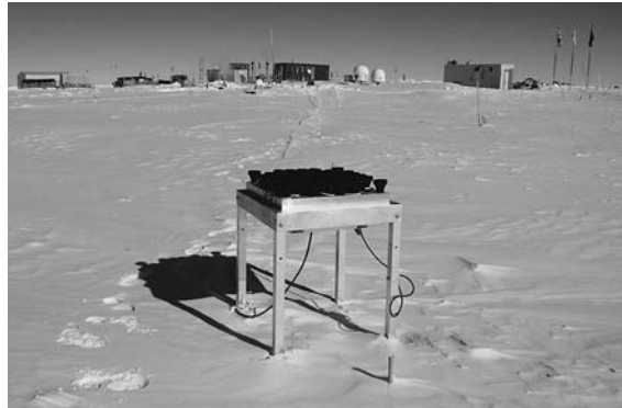
図 1 ドームふじに設置した SODAR. ヒーターはノイズ源となったため使用しなかった Fig. 1. SODAR installed at Dome Fuji Station (Photo by H. Motoyama, JARE-48).
