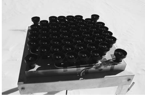
図 2 撤収時の SODAR. 音響ホーン部に雪の吹きだまりは発生しなかった.
