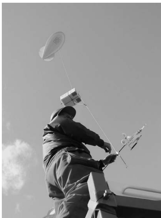
図7 エアロゾル・気象観測測器の係留方法(第45次隊長田隊員撮影)
