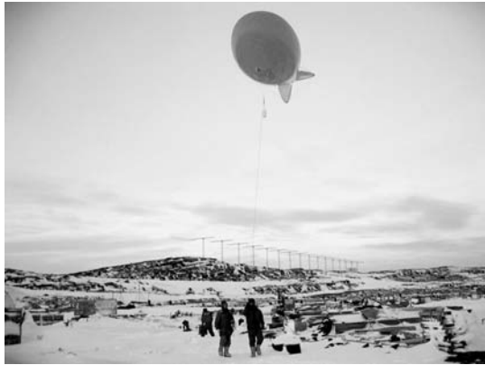
図9 係留気球の移動方法（第46次隊長谷川隊員撮影） Fig. 9. Transport procedure of tethered balloon from the hanger to C heliport (photo by Y. Hasegawa, JARE-46).
