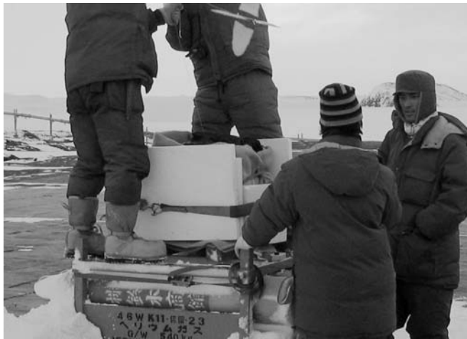
図2 電動ウインチの保温(第46次隊長谷川隊員撮影)。ウインチ右側にはリモコンを出すため、小さめの発泡スチロール材にしてある。
