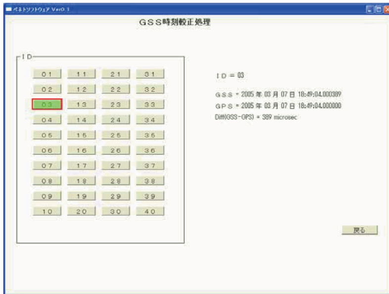
図 5 GSS 時刻校正処理画面 Fig. 5. "GSS clock calibration" panel.
