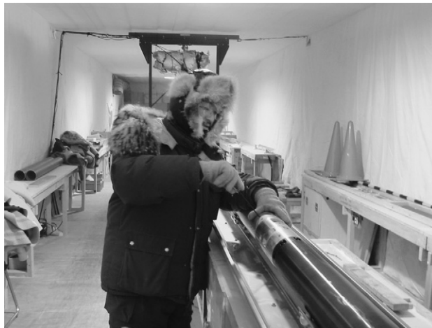
図23 深層ドリルの組み立て(11月29日)
