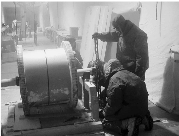
図21 ケーブル巻き換え機へのケーブルドラムの固定(11月13日)
