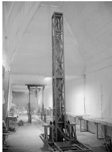
図 19 鉛直に立ったマスト (10月18日) Fig. 19. Mast vertically standing in the new deep ice coring site (October 18, 2003).
