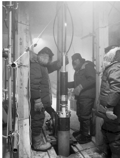
図5 第3リーマー(大口径アンチトルクを使用, 4月18日)
