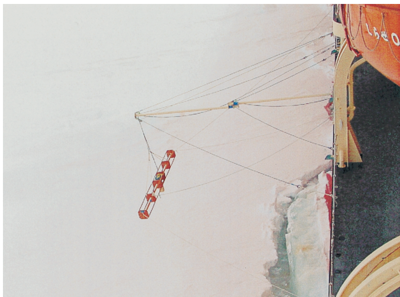
写真 1 EM 観測装置の設置 EM センサ及びレーザ距離センサは保護用の木枠に収納されている Photo 1. Setup of EM Instruments. The EM and the laser distance sensor are contained in the wooden frame.
