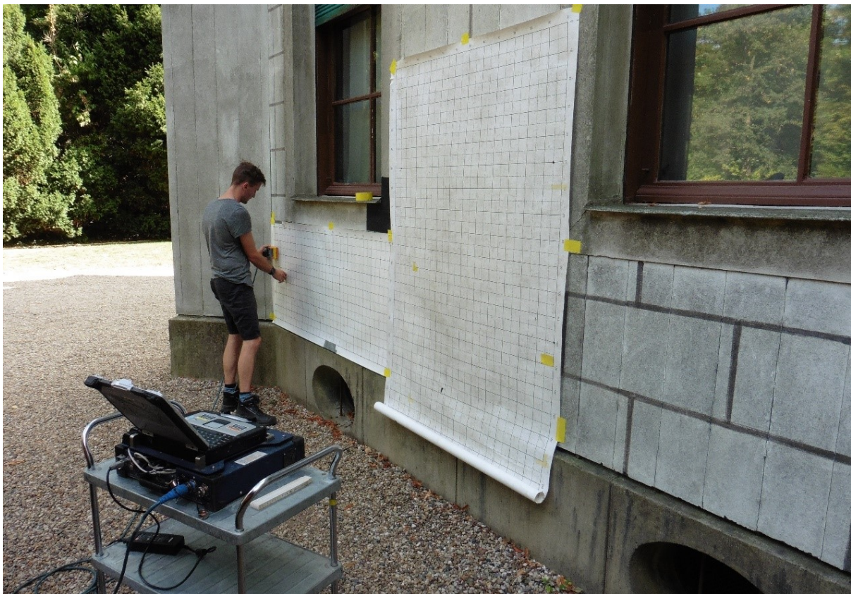
Abbildung 4.9: Radarmessung an der Schlossfassade mit dem GSSI SIR 20 und einer 2 GHz Radarantenne.
