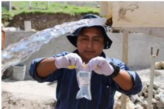
Fotografía 3: Toma de muestras para el monitoreo de calidad del agua
