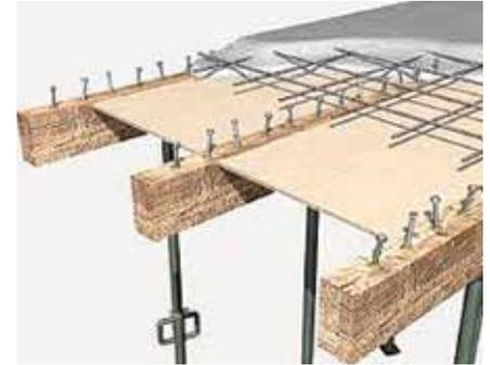
Refuerzo de forjado con estructura mixta madera-H<sup>2</sup>A<sup>2</sup>
