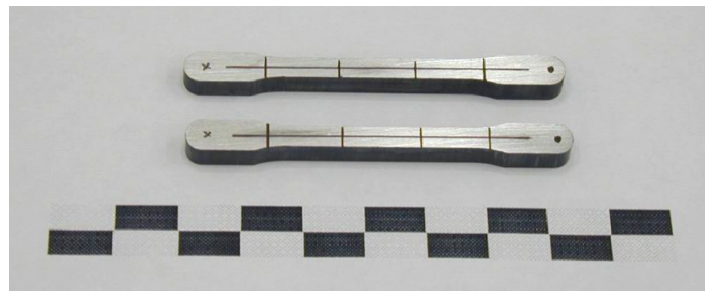
Fig. 3.16 Marcas realizadas sobre probetas de tracción para medir el alargamiento.
