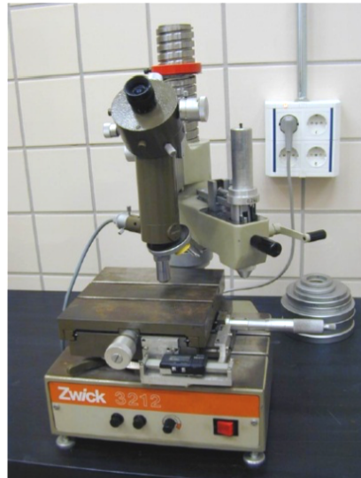
Fig. 3.17 Microdurómetro empleado para la medida del alargamiento de las muestras de tracción.
