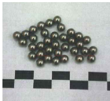
Fig. 3.3 Bolas de acero al cromo níquel para la molienda.
