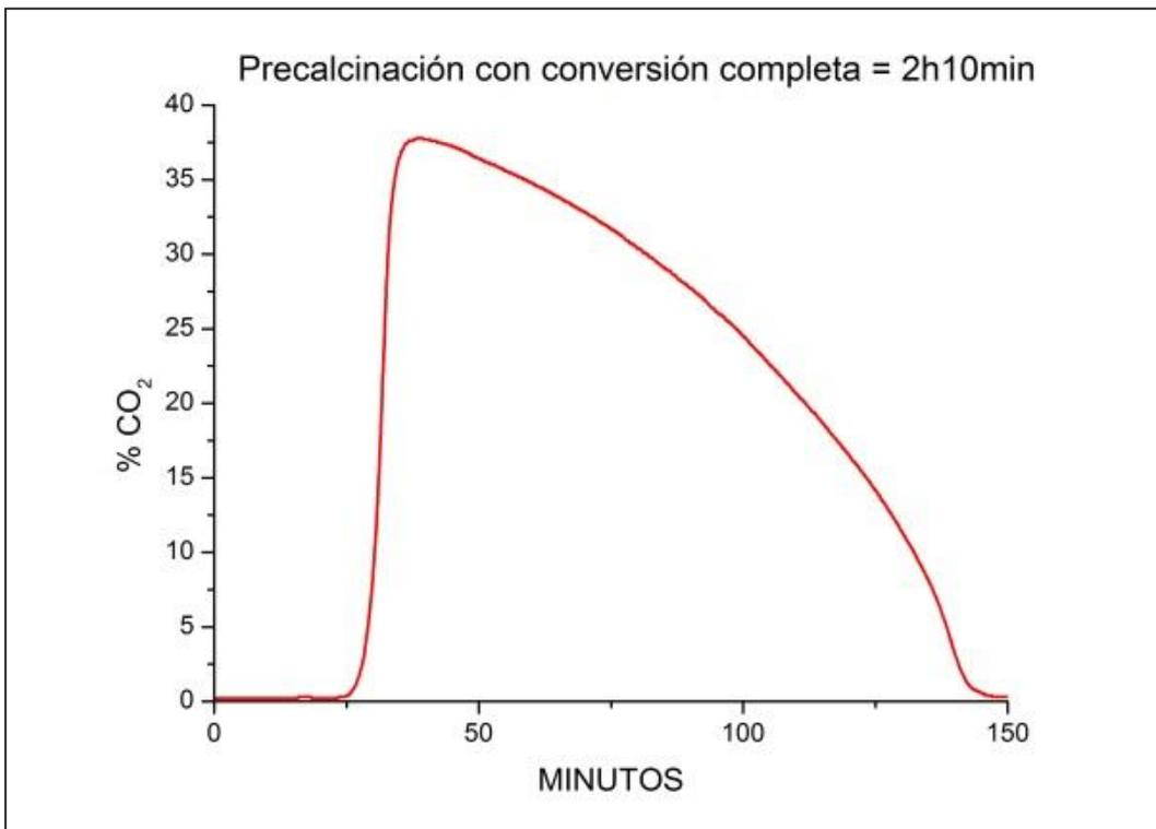
Fig. 3.9: Curva del %CO<sub>2</sub> emitido en una precalcinación completa en 2h 10' con 100cm<sup>3</sup>/min sin aditivo.
