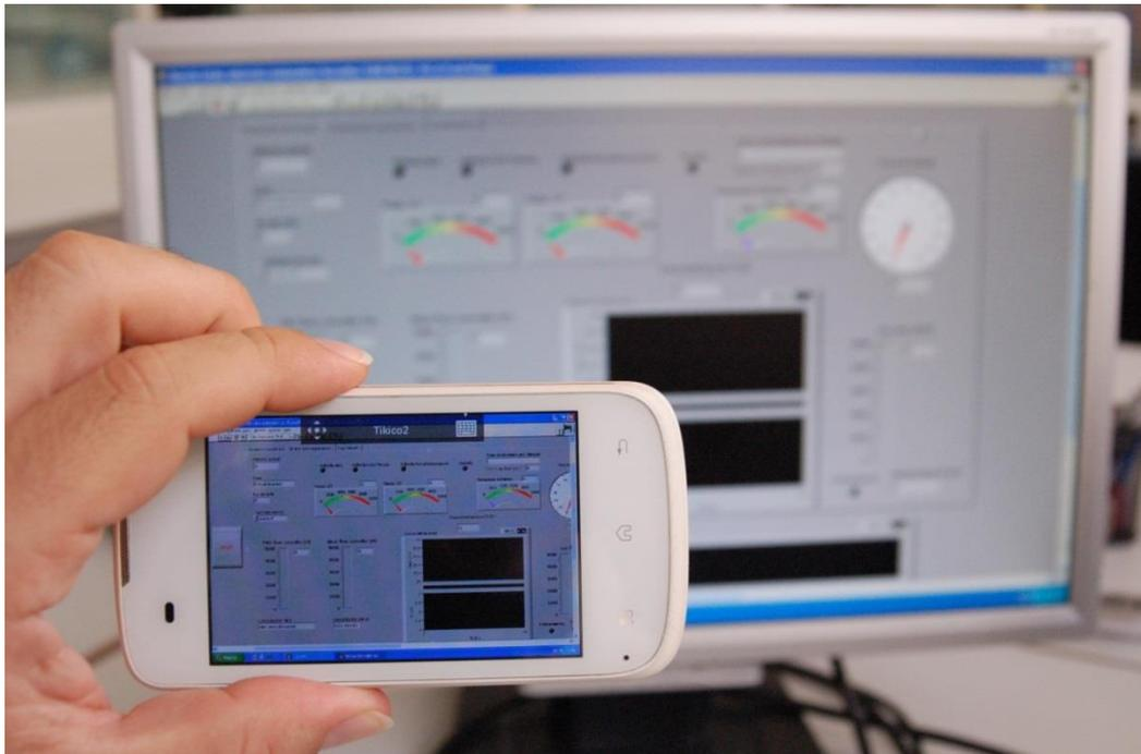
Fig. 2.6: Ejemplo de control remoto del experimento mediante el móvil..
