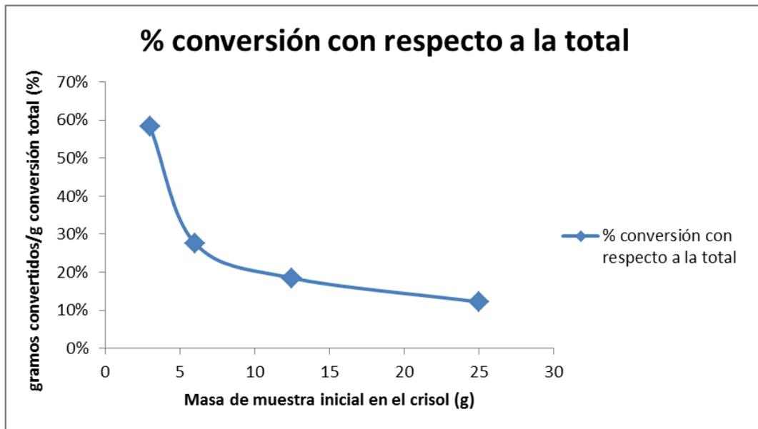
Fig. 3.10: Porcentaje de conversión de  $\text{CaCO}_3$  a  $\text{CaO}$  en función de la masa inicial después de precalcinarse durante 10 minutos 4 crisoles con masas de 3, 6, 12.5 y 25g respectivamente.
