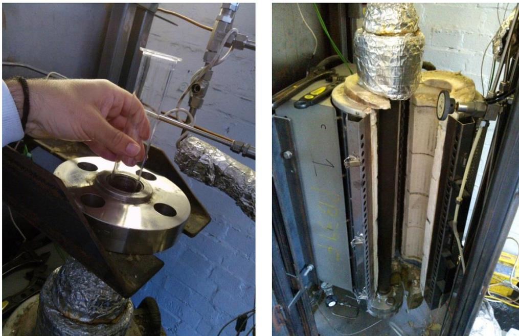
Fig. 4.2: Reactor de cuarzo siendo introducido en el horno (izquierda). Vista del horno abierto (derecha).
