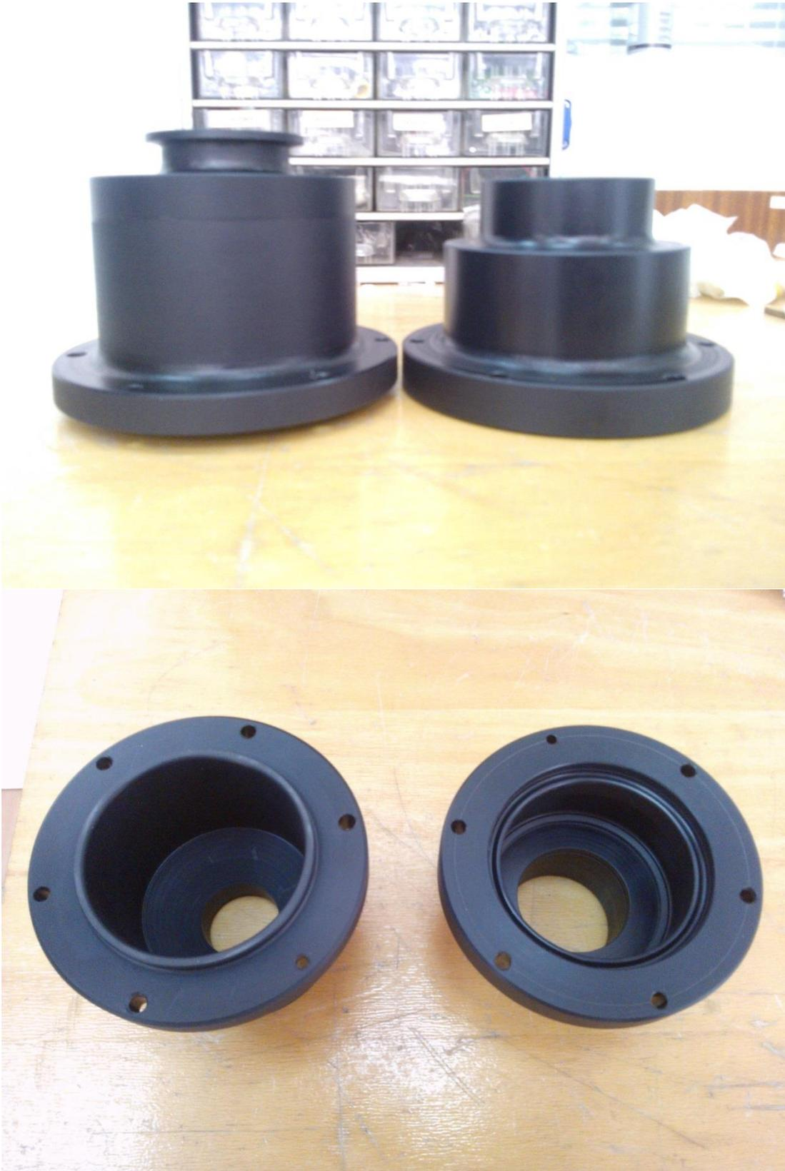
Fig. 2.7: Planta y alzado del útil fabricado para la membrana de silicona (sistema de sonido).
