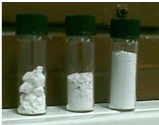
Fig. 1.7: Materiales con distinta cohesión. De izquierda a derecha (de mayor a menor cohesión);  $\text{CaCO}_3$  fina ( $d < 425 \mu\text{m}$ ),  $\text{CaCO}_3$  gruesa ( $d < 710 \mu\text{m}$ ) y  $\text{CaCO}_3$  fina + 20% nano-partículas de  $\text{SiO}_2$ .
