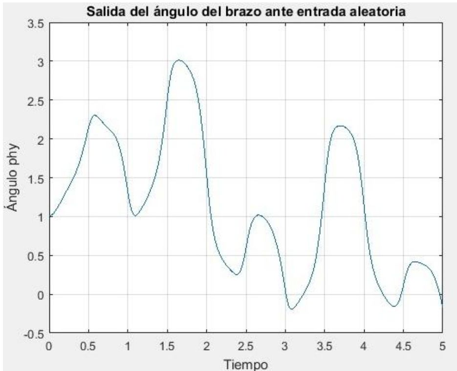
Figura 3-9. Ángulo del brazo del péndulo ante la entrada aleatoria.
