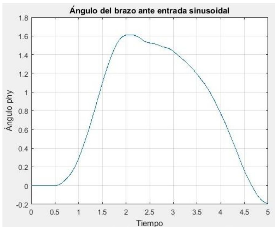
Figura 3-12. Ángulo del brazo del péndulo ante la entrada sinusoidal.
