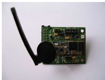
Figura 8. Sistema electrónico para comunicaciones inalámbricas: módulo Bluetooth.
