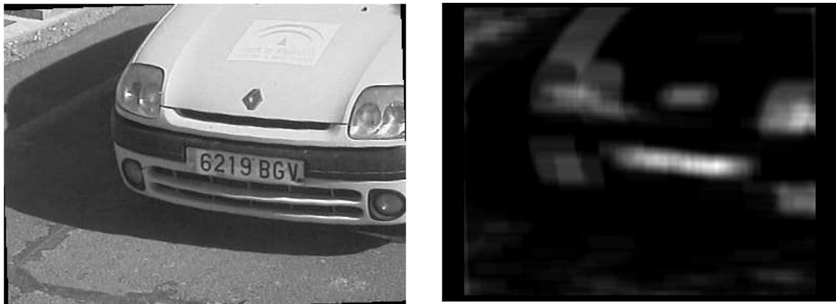
Figura 9. Izq: Imagen original del frontal de un vehículo, incluyendo su matrícula. Der: Imagen en la que se ponen de manifiesto las regiones que son candidatos más probables a matrícula.
