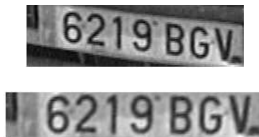
Figura 11. Extracción de la subimagen conteniendo la matrícula y corrección de la orientación.
