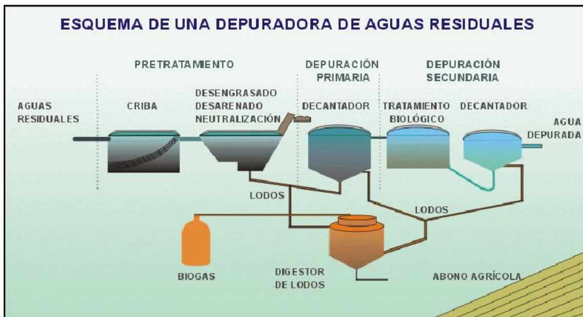
Figura II.16. Esquema de procesos de una EDAR convencional.
