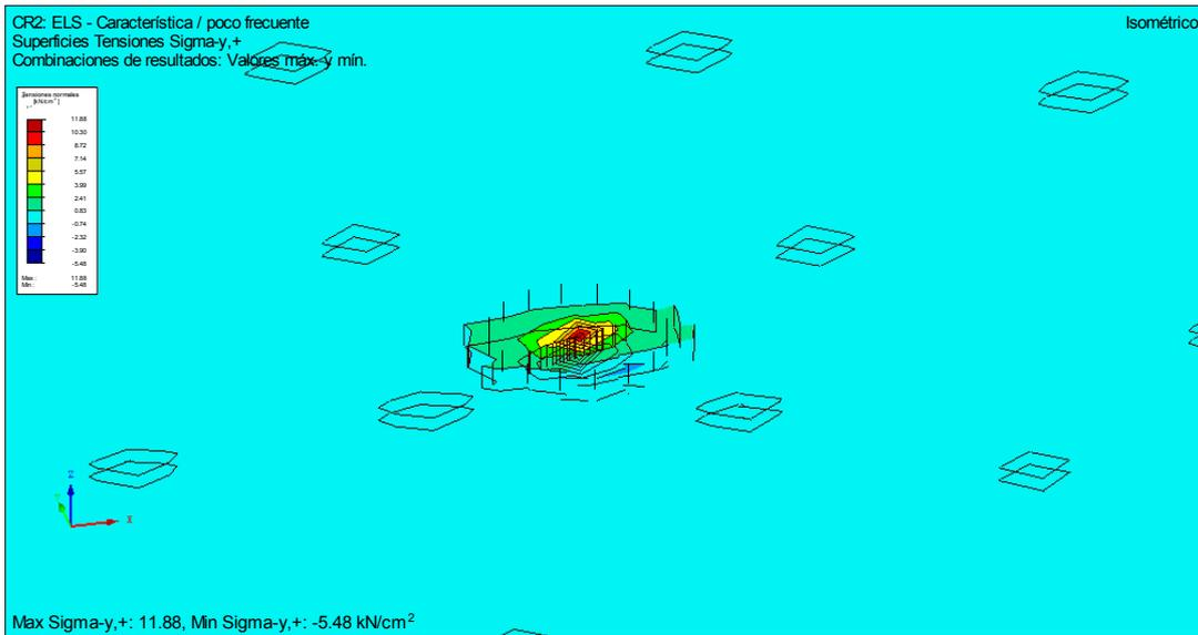
**Fig.143. Tensiones normales en losa maciza. Vigas empotradas en borde de pilar**
