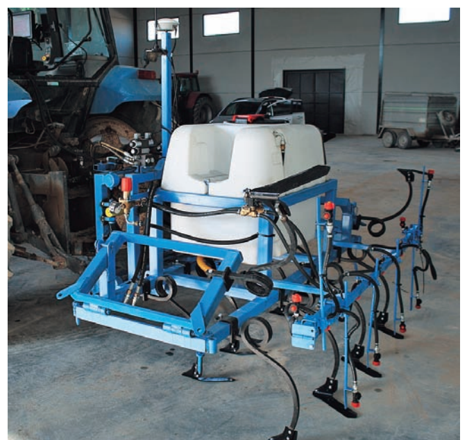
Figura 4. Equipo desarrollado para el control optimizado de mala hierba.
