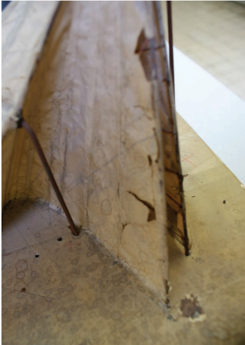
Fig. 122.- Segunda maqueta. Diversos tanteos y pruebas de posición de los pilones metálicos en la base de madera.
