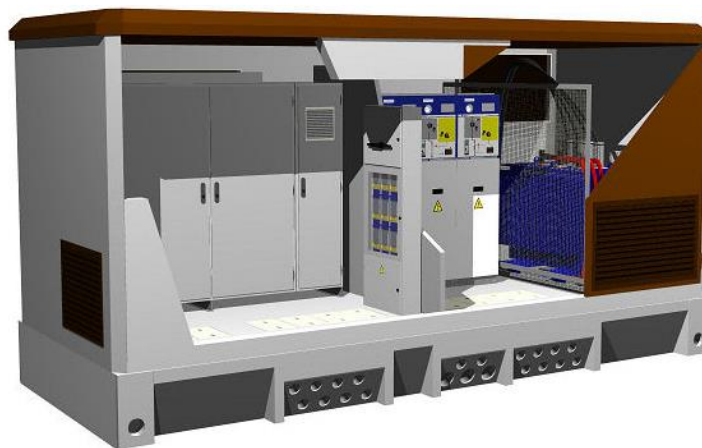
Ilustración 4.8. Centro de Transformación (Transformador y celdas de protección).
