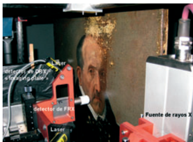
3. Equipo de difracción y fluorescencia de rayos X portátil diseñado y construido en el Centre de Recherche et de Restauration des Musées de France. Foto: Jacques Castaing
