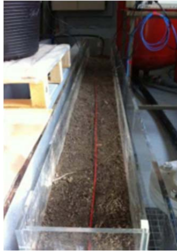
Figura 1. Detalle del contenedor de suelo del jardín con el cable de fibra óptica.
