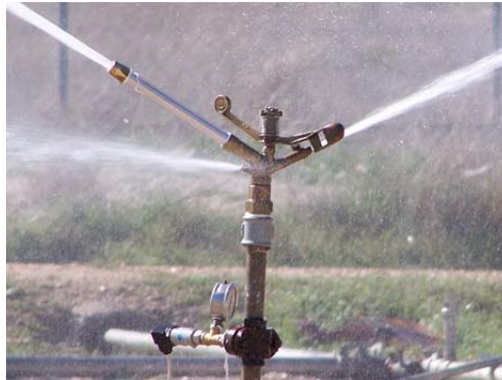
Figura 1. Detalle del aspersor de gran tamaño A-D-5 con tres boquillas
