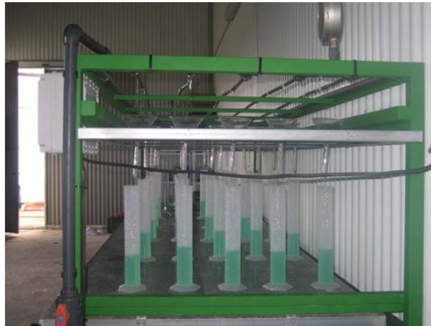
Figura 1. Banco de ensayo diseñado según norma UNE 68-075-86
