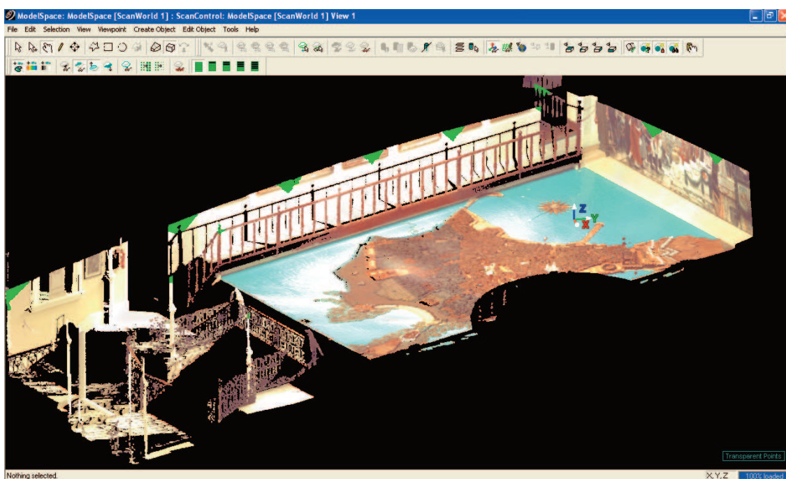
Figura 5.7.- Nube de puntos 3D del primer estacionamiento. Aplicación Leica Cyclone 6.0.
