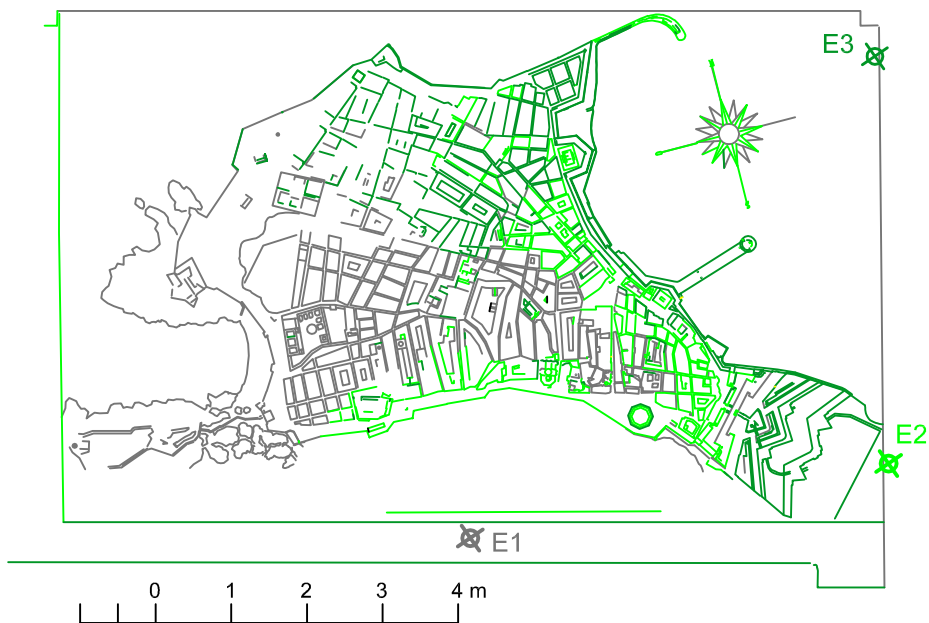
Figura 5.15.- Planimetría referenciada con la información correspondiente a los tres primeros estacionamientos. Escala 1/100. Fuente: Elaboración propia
