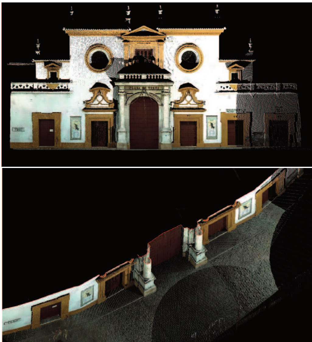
Figura 5.28.- Vistas del alzado y sección de la nube de puntos correspondiente a la fachada principal de la Maestranza de Sevilla. Fuente: Proyecto 0155/0101
