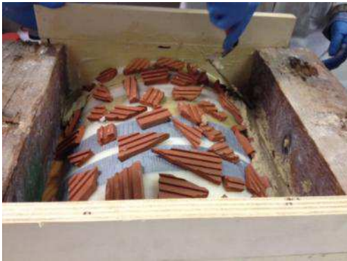
Fig. 7 “Proceso de elaboración de la nueva pieza. a. Colocación de los restos cerámicos reciclados. b. Colocación de la fibra de vidrio”. Fuente: los autores.
