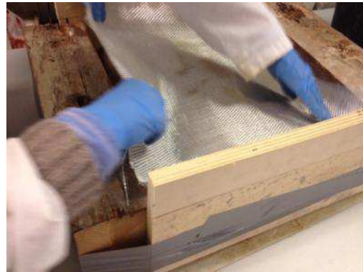
Fig. 7 “Proceso de elaboración de la nueva pieza. a. Colocación de los restos cerámicos reciclados. b. Colocación de la fibra de vidrio”. Fuente: los autores.
