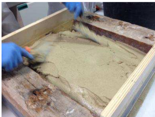
Fig. 8 “Vertido del mortero. a. Enrasado de la cara superior hasta una perfecta planeidad. b”. Fuente: los autores.
