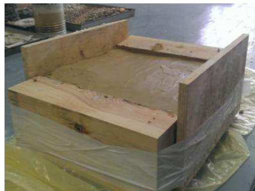
Fig. 8 “Vertido del mortero. a. Enrasado de la cara superior hasta una perfecta planeidad. b”. Fuente: los autores.
