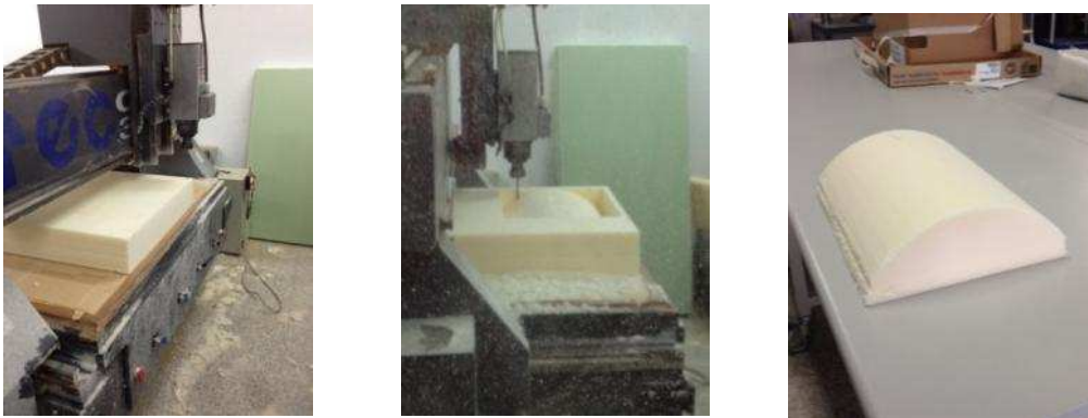
Fig. 5 “Proceso de fabricación del molde”. Fuente: los autores.
