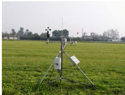
Foto 1. Estación meteorológica automática de la Red SIAR, usada para estimar la ET_0 .
