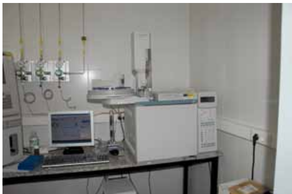
Figura 22. Equipo para el análisis de cromatografía gaseosa. Servicio General de Investigación Agraria. Universidad de Sevilla.
