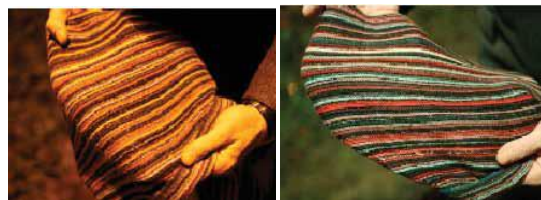
Fig. 1 - Bufanda iluminada con vapor de sodio a baja presión Ra<40 y la misma bufanda iluminada con LED Ra=60 [2]
