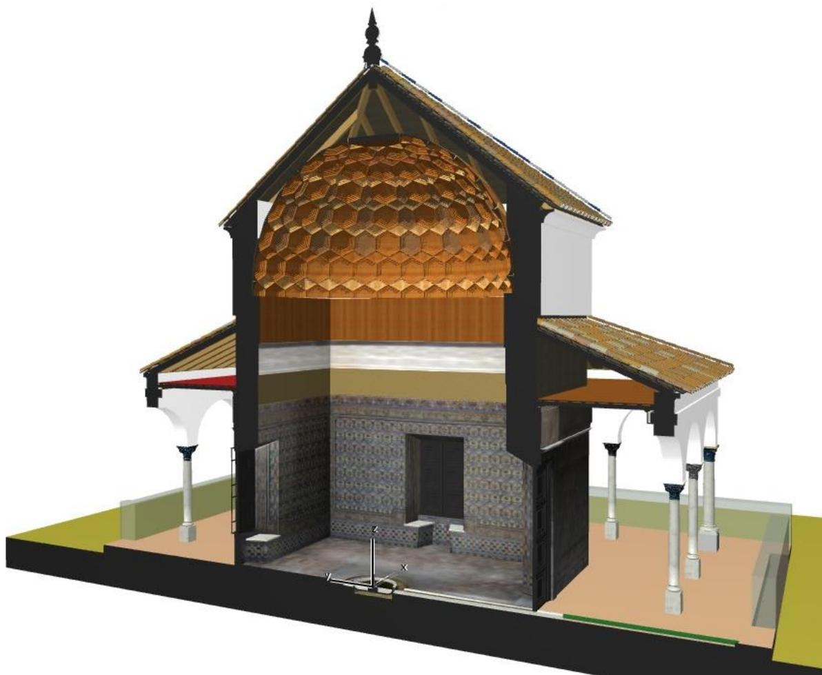
Fig. 11. Sección 3D hacia el Este del Cenador de Carlos V. Modelado con ArchiCAD. Autor: E. Nieto, 2014.
