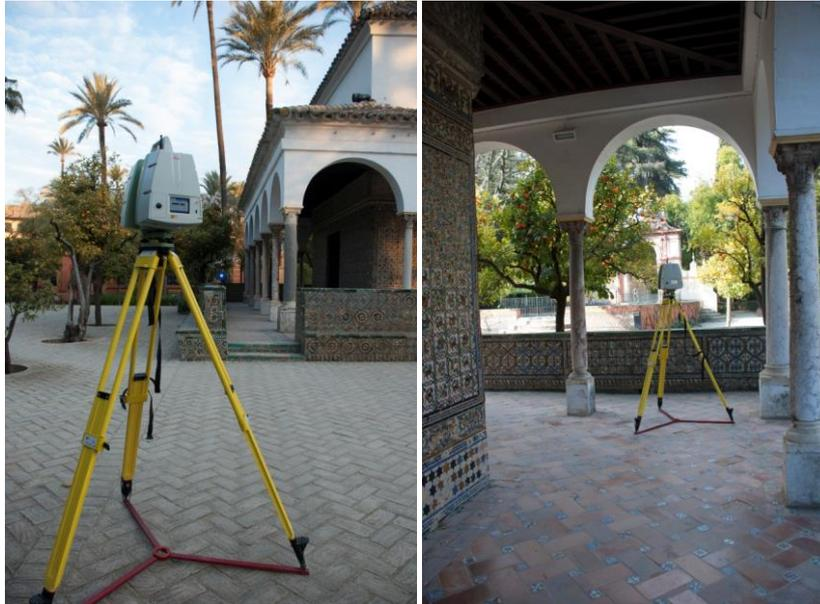
Fig. 4. Emplazamientos del equipo Leica C10 en el Cenador de Carlos V: a) posición exterior suroeste; b) posición interior sureste. Levantamiento del profesor J.A. Barrera, Dto. Ing. Gráfica. Universidad de Sevilla, 2012.
