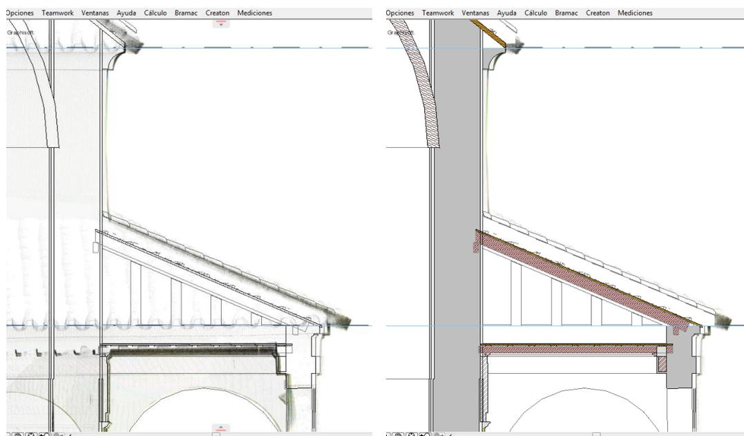
Fig. 10. Comparativa del muro sobre el faldón de cubierta del modelo con la imagen de referencia: a) Opción Trazar con Referencia activada; b) Con la opción desactivada. ArchiCAD 16/17. Autor: E. Nieto, 2013.
