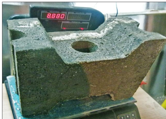
fig. 3 “Bloque Hache Plus con hormigón EPS 1000 k/m 3 ”
