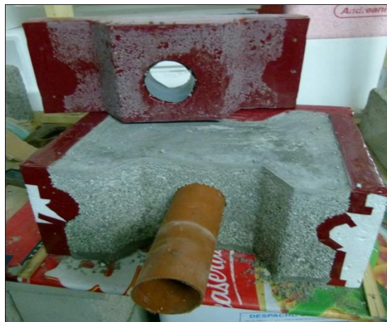
fig. 5 “Molde de Bloque Hache con EPS recuperado y bloque resultante”
