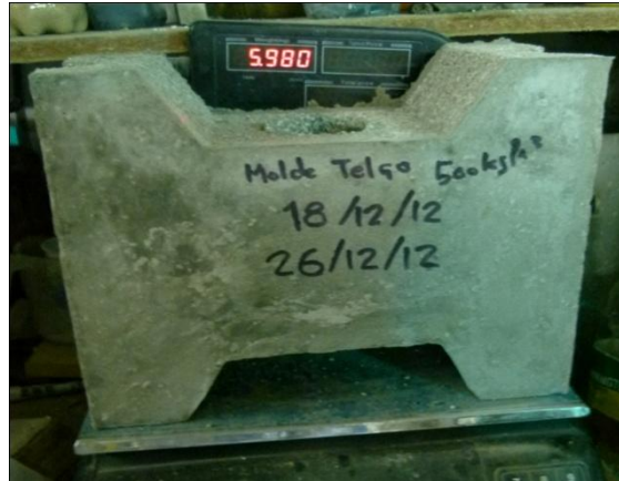
fig. 2 “Bloque Hache con hormigón EPS 500 k/m 3 ”
