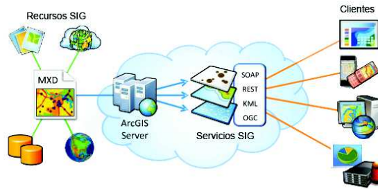
Figura 2. Esquema de funcionamiento de un servidor SIG (ArcGIS Server).
