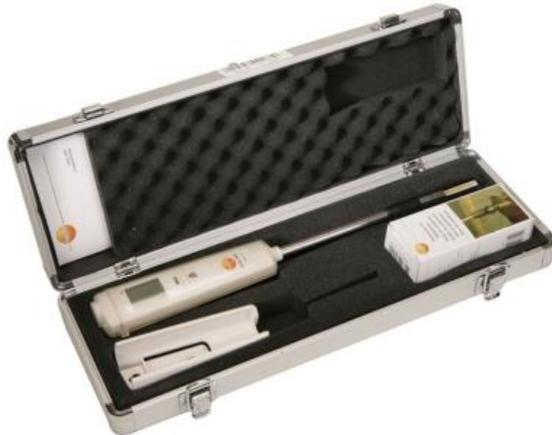
**Figura 7 Medidor de la calidad del aceite**
