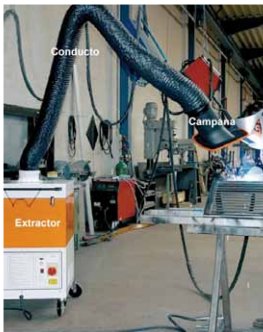
Figura 2. Partes de un sistema de extracción localizada.
