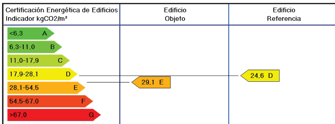
Fig. 4. Gráfico del grado de certificación energética de la vivienda objeto del estudio.
