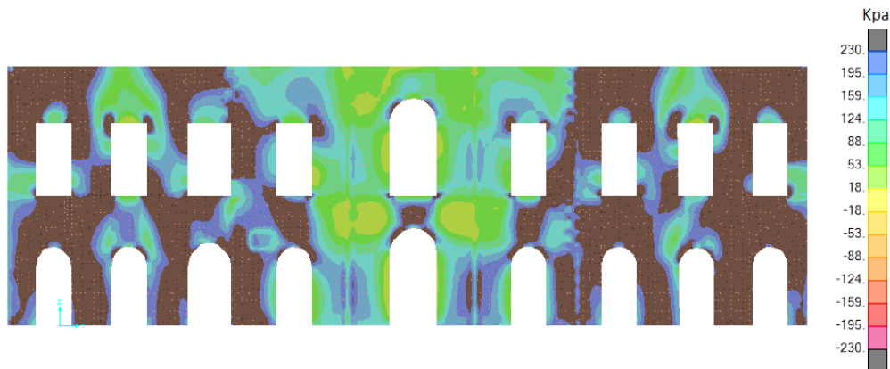
Figura 14: Envolvente de tensiones de corte. Resultados análisis TH para registro de aceleraciones del terremoto de febrero de 2010, estación Santiago Centro.
