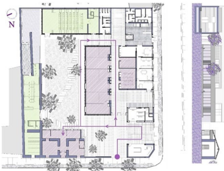
Figura 8. Planta baja y sección por el jardín de la propuesta del Museo Casa-Natal. Se resaltan espacios expositivos y usos culturales complementarios (biblioteca y auditorio) MASCORT ALBEA, Emilio: “Casa-Museo Violeta Parra”, Proyecto Fin Carrera ETSAS , p. 4.
