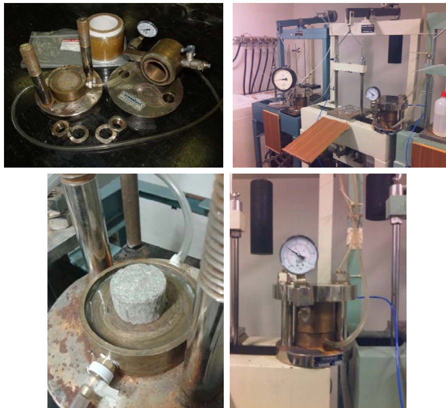
Figura 4-18. Equipo de membrana de presión usado en la investigación del Laboratorio de Mecánica del Suelo de la Escuela de Arquitectura de Sevilla
