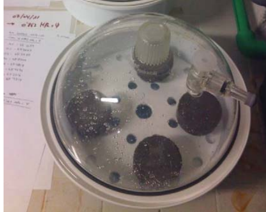
Figura 4-21. Imagen de los desecadores de vacío durante un escalón del ensayo de equilibrio de vapor
