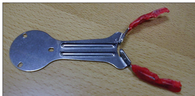
Fig. 1. Fijación para el emisor del ARCUSdigma.
