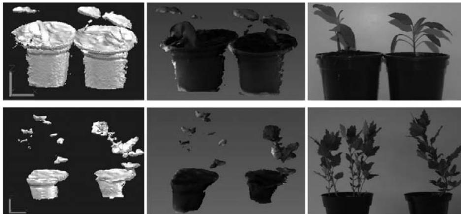
Figura 2. Reconstrucción 3D de *Xanthium strumarium* (arriba) y *Chenopodium album* (abajo) creada por superposición de nubes de puntos usando un sensor Kinect a 0,8 m de distancia y un ángulo de inclinación de 45°.
