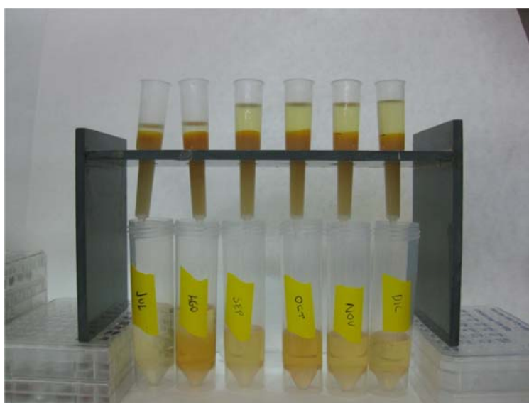
Fig. 4.21. Muestras de filtros de aerosoles después del paso de las muestras por la columna de Fe.
