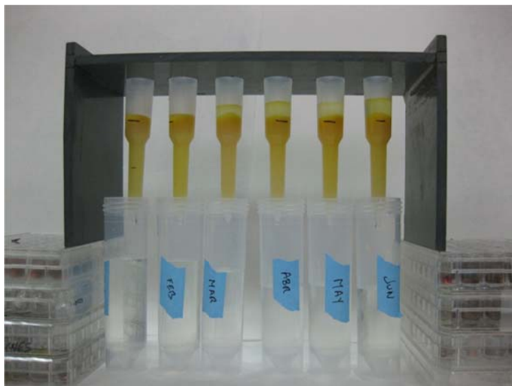
Fig. 4.26. Disolución obtenida tras el paso de la muestra por la columna de Fe , siguiendo el procedimiento radioquímico desarrollado en nuestro laboratorio. Se observa la disolución translúcida y homogénea.
