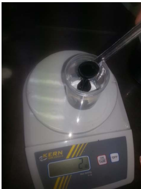
Figura 4-18. Preparación del compuesto Belzona 5831
