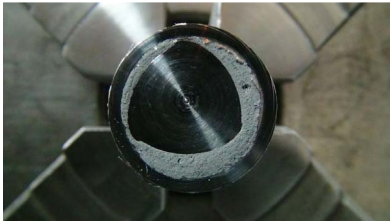
Figura 4-23. Ejemplo de un corte para una probeta de acero AISI 304
