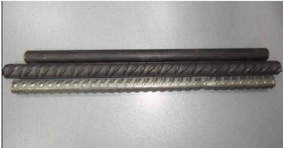
Figura 4-1. Tipologías de probetas ensayadas según disposición de corrugas
