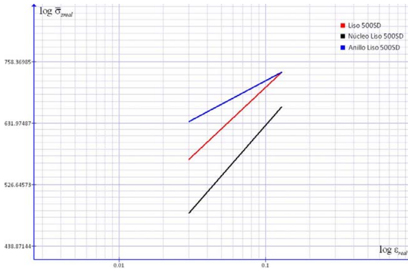
Figura 5-29. Funciones de Hollomon para anillo y núcleo de acero liso 500SD
