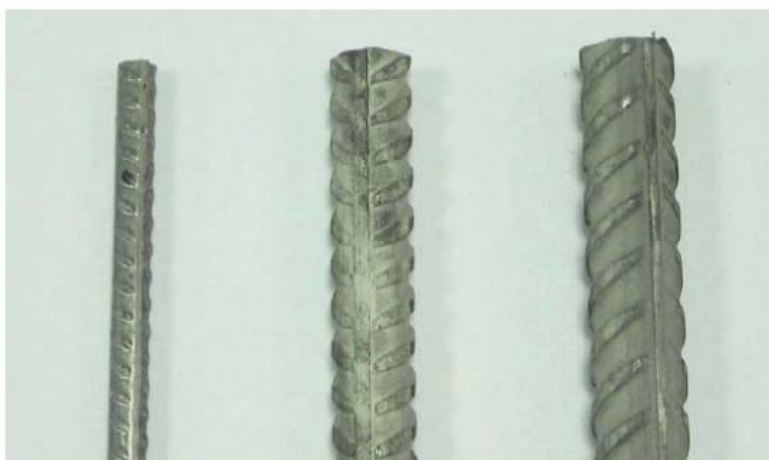
Figura 2-15. Diseño de corrugas para barras de acero inoxidable laminadas en frío (izquierda) y laminadas en caliente (centro y derecha)
