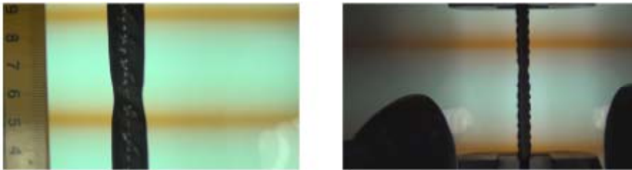
Figura 4-10. Pruebas en probetas de acero B500SD para determinar el perfil más idóneo de grabación
