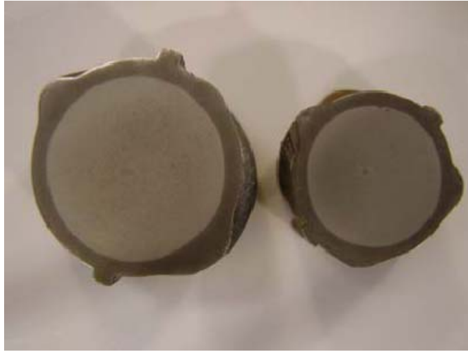
Figura 2-12. Barras de acero corrugado preparadas para una observación microscópica
