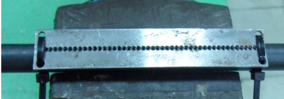
Figura 4-7. Plantilla para el marcado de la longitud calibrada en barras lisas
