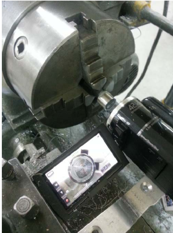
Figura 4-21. Ejecución y grabación de los cortes
