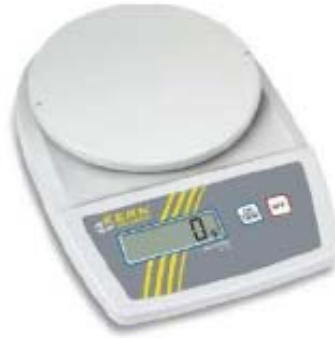
Figura 4-6. Balanza utilizada para el pesado de las probetas
