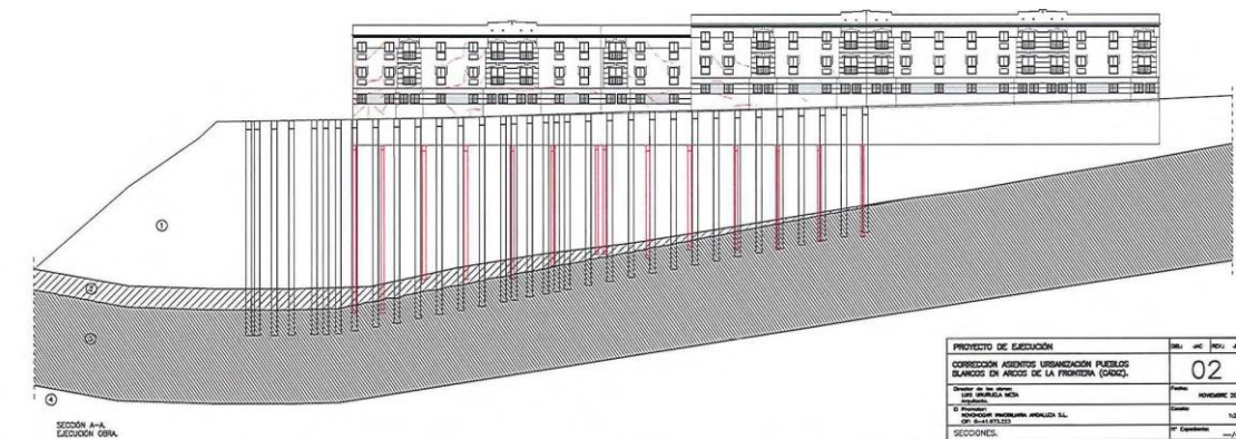
Ilustración 63. Sección de Consolidación. (Luis Urruñuela. Arquitecto. 2009)
