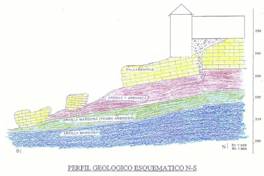
Ilustración 105. Esquema de deslizamiento de la ladera.
