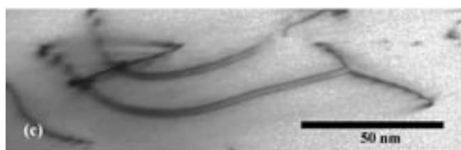
Fig. 2- Micrografías de transmisión mostrando la subestructura de dislocaciones de una muestra de TeO<sub>2</sub> deformada a lo largo de la dirección cristalográfica [110]. En la micrografía (a) se señalan evidencias de kinks mediante flechas. Se muestra detalle de 3(c), en el que se aprecia la disociación de dislocaciones. El vector *g* utilizado era de tipo [020].
